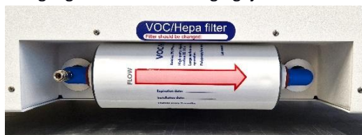
Figur 12.3 Korrekt monteret VOC/HEPA-filter
