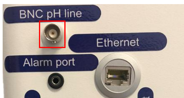
Figur 18.1 Tilslutning af en BNC pH-linje
