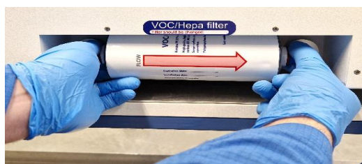
Figur 12.2 Fremgangsmåde for isætning og fjernelse af VOC/HEPA-filter
