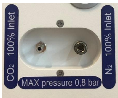
Figur 11.1 Gasindtag på bagsiden af MIRI® II-12 multiroom IVF-inkubatoren
